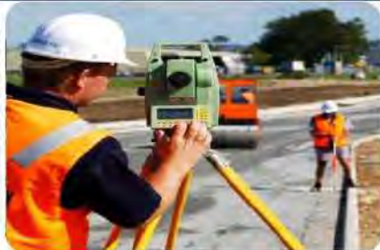
تحديد المسافات باستخدام جهاز Total station
